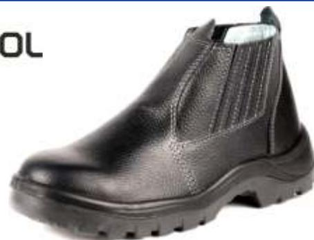
Botina de segurança com fechamento em elástico lateral recoberto, confeccionada em vaqueta estampa relax, forração interna da gáspea, forro do cano com alto poder de absorção. Biqueira de aço, solado poliuretano (PU) bidensidade, e tecnologia Dry Comfort; forro que absorve a umidade gerada pelo suor.
