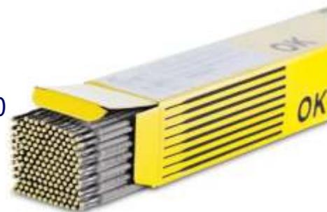
O Eletrodo Inox OK 68.65 deposita aço inox resistente a corrosão sob tensão, com boa resistência a oxidação superficial até 1150 °C; Especialmente indicado na soldagem de aços de composição desconhecida, de escassa soldabilidade ou dissimilares; Ideal também p/ camada de amanteigamento antes do revestimento duro;
