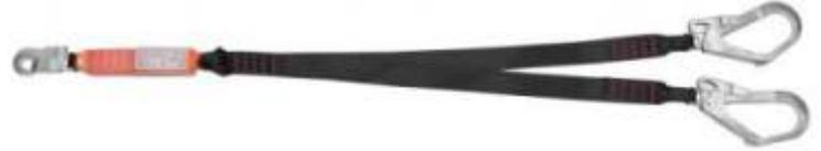
Talabarte Y fita com absorvedor de energia e conectores classe A (abertura de 55mm) e classe T (abertura de 18mm).
