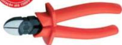
Alicate de corte diagonal, modelo sueco iox isolado NBR9699. Aço Gedore-Vanadium. Fosfatizado e faces lixadas. Tratamento térmico total e indução no corte. Projetado para cortar arame duro de até 1,6 mm.
