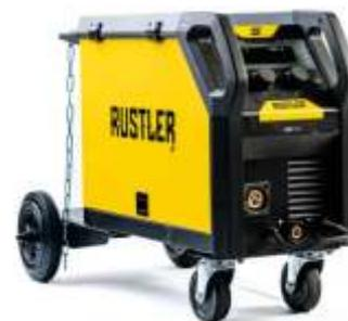
A máquina de solda MIG/MAG é um equipamento utilizado para realizar soldagem por arco elétrico. O processo MIG (Metal Inert Gas) utiliza um gás inerte, como o argônio, para proteger o arco elétrico e a poça de fusão da solda, enquanto o processo MAG (Metal Active Gas) utiliza um gás ativo, como o dióxido de carbono, para produzir uma reação química que ajuda a proteger o arco elétrico.
