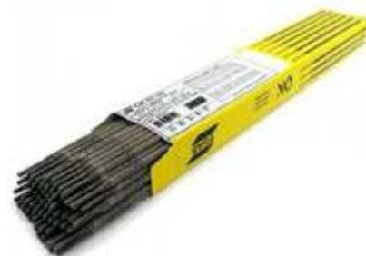
Eletrodo rutilico para aços inoxidáveis resistentes aos ácidos e ao calor. Deposita aço inox, tipo 19/12 com baixíssimo teor de carbono. Também usado em aços estabilizados não sujeitos a ataque corrosivo muito severo. Resistente à corrosão intergranular.
