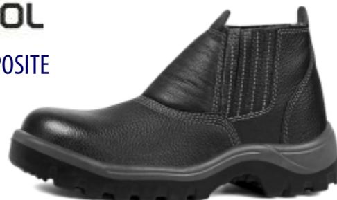
Calçado de segurança de uso profissional tipo botina, fechamento em elástico, confeccionado em couro curtido ao cromo, cor preta, palmilha de montagem em não tecido montada pelo sistema strobel, biqueira de composite, solado de poliuretano bidensidade preto injetado direto no cabedal, para risco elétrico.
