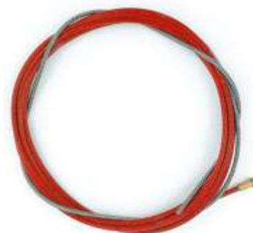
O guia espiral tocha MIG usado como conduíte elétrico onde passa o arame para dentro tocha.
