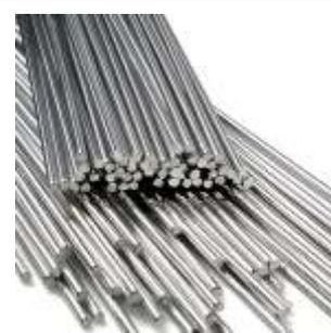
É uma vareta sólida, inoxidável, indicada para soldagem de aços inoxidáveis do tipo 18% Cr 8% Ni com baixo teor de carbono. Também é indicada para aços similares estabilizados ao Nb, se a temperatura de trabalho não exceder 350 °C.
